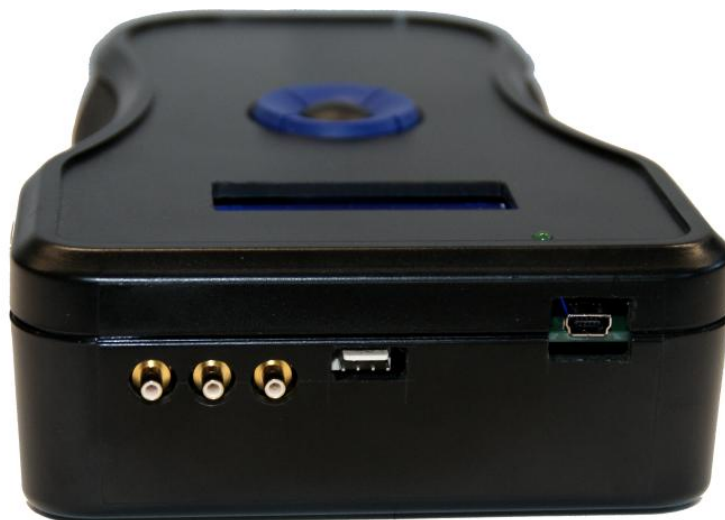
Abb. 38: Anschlüsse des Kapazitätsmessgerätes: SHLD, CIN(-) CIN(+), Temperatursensor-Anschluss, USB (v.l.)
