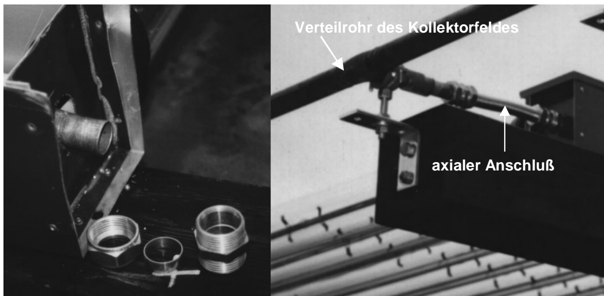
Abbildung 3: verdrückter Anschluß des Kollektor-Sammlerrohres und dazugehörige Schneidringverschraubung, erste Verrohrung mit axial angeordnetem Wellrohr
