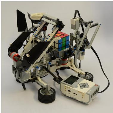
In einem Schülerpraktikum wurde bereits ein Roboter gebaut, welcher in der Lage ist, den Zauberwürfel zu drehen und zu kippen. Darauf aufbauend soll zunächst mittels eines Farbsensors die aktuelle Konfiguration des Würfels erfasst und im Anschluss dann einen Sortieralgorithmus implementiert werden.
