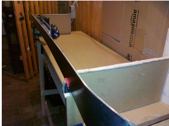
Abbildung 1: Selbst gebauter Skihalter zur seitlichen Kantenpräparation (links) und zur Belagspräparation (rechts)
