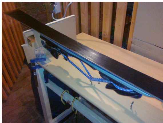
Abbildung 5: Abspannen des Skis zur Fixierung
