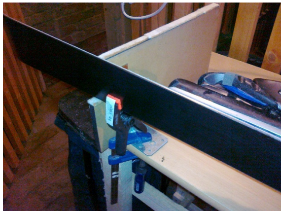
Abbildung 4: Festklemmen des Ski mit Hilfe von Leimzwingen
