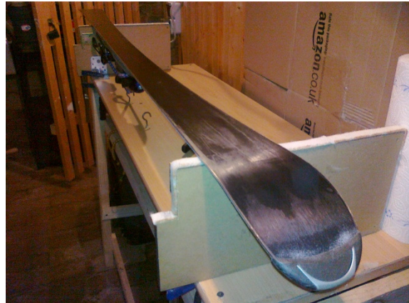
Abbildung 1: Selbst gebauter Skihalter zur seitlichen Kantenpräparation (links) und zur Belagspräparation (rechts)
