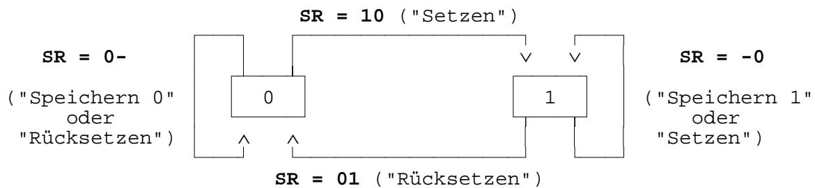
Man vereinbart, daß eine Kante dann und nur dann durchlaufen wird, wenn das Taktsignal aktiv ist (hier:  $C = 1$ ). Bei inaktivem Taktsignal verharrt das Flipflop in seinem "alten" Zustand.
