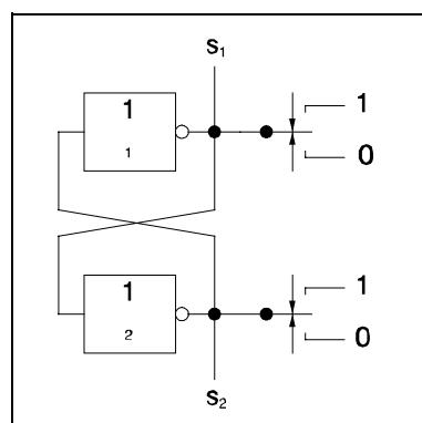
Wir betrachten zwei kreuzgekoppelte Negatoren, einen sog. Flipflop-Kern. An den Ausgängen  $s_1$  und  $s_2$  erkennen Sie zwei Taster. Jeder Taster hat drei Stellungen: 0, 1 und die hier gezeichnete Mittelstellung. Wenn sich ein Taster in der Stellung 0 (1) befindet, dann soll der Ausgang, an den der Taster angeschlossen ist, den Pegel 0 (1) annehmen. Befindet sich der Taster in Mittelstellung, bleibt der Ausgang sich selbst überlassen.
