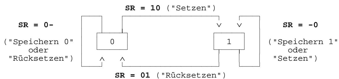
Beachten Sie die Unterschiede in der Kantenbeschriftung im Vergleich zu dem Automatengraphen, der am Anfang der Überlegungen stand! Die zuletzt angegebene Form werden wir in der Folge ausschließlich verwenden!
