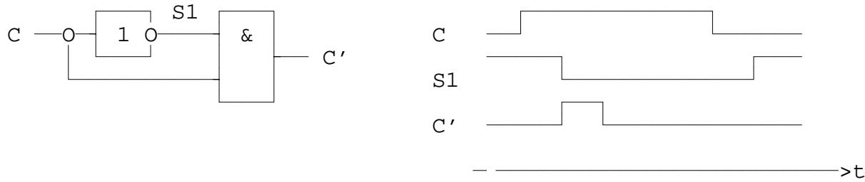
Die Tabellen und der Automatengraph eines taktflankengesteuerten Flipflops unterscheiden sich nicht von denen des entsprechenden taktzustandsgesteuerten Flipflops. Man vereinbart, daß eine Kante dann und nur dann durchlaufen wird, wenn das Taktsignal eine aktive Flanke (hier: steigende Flanke,  $C = 01$ ) durchläuft. Sonst verharrt das Flip-flop in seinem "alten" Zustand.
