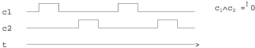
Die Orthogonalitätsbedingung ist gerade noch erfüllt, wenn gilt  $c_2 = /c_1$ . Dann können auch zwei in einem Datenstrang liegende statische Flipflops zu einem Doppel-Flip flop zusammengefaßt werden.
