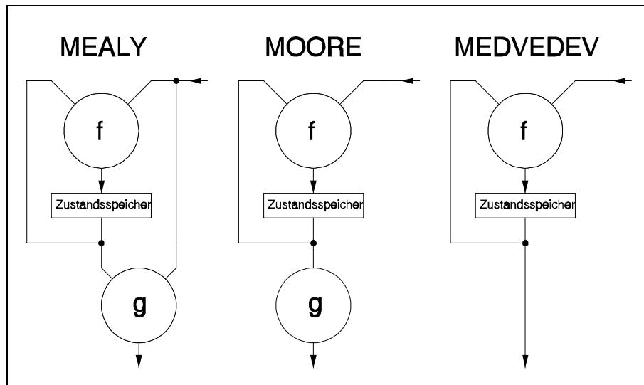
Die Zustands- und Kantenbeschriftung im Automatengraphen ist für die drei Automatentypen unterschiedlich:
