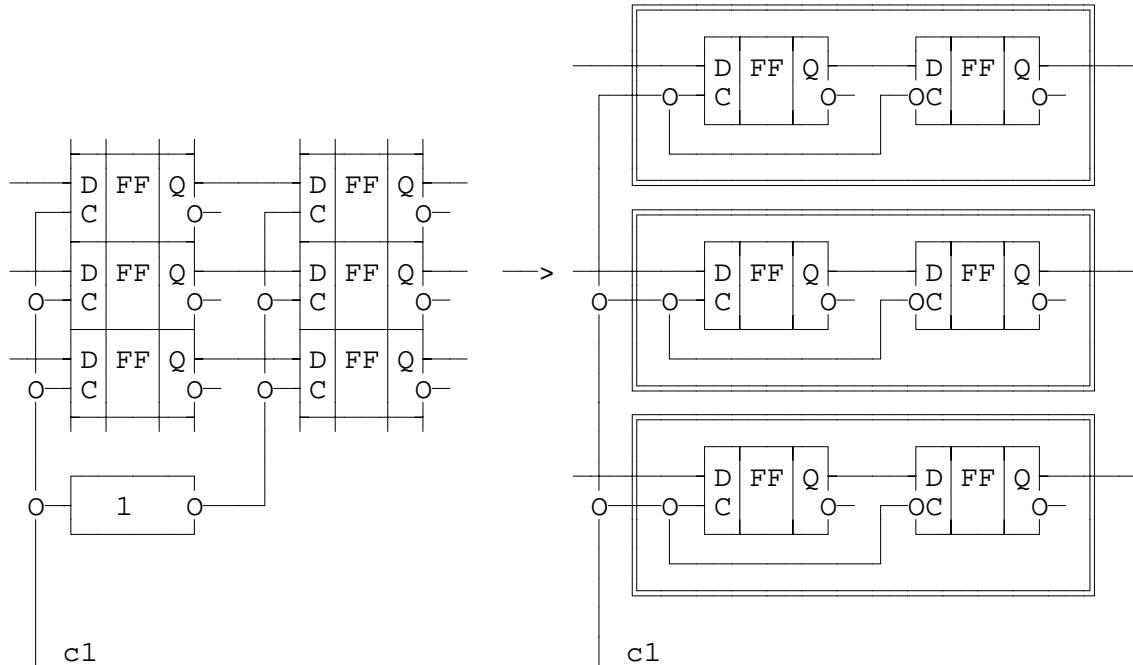
Da das jeweils rechte Teil-Flip flop eines solchen Doppel-Flipflops die Information aus dem jeweils linken Teil-Flip flop "sklavisch" übernimmt, nennt man das rechte Teil-Flip flop "Slave", das linke Teil-Flip flop Master und das gesamte Doppel-Flip flop "Master-Slave-Flip-flop" (MS-FF).
