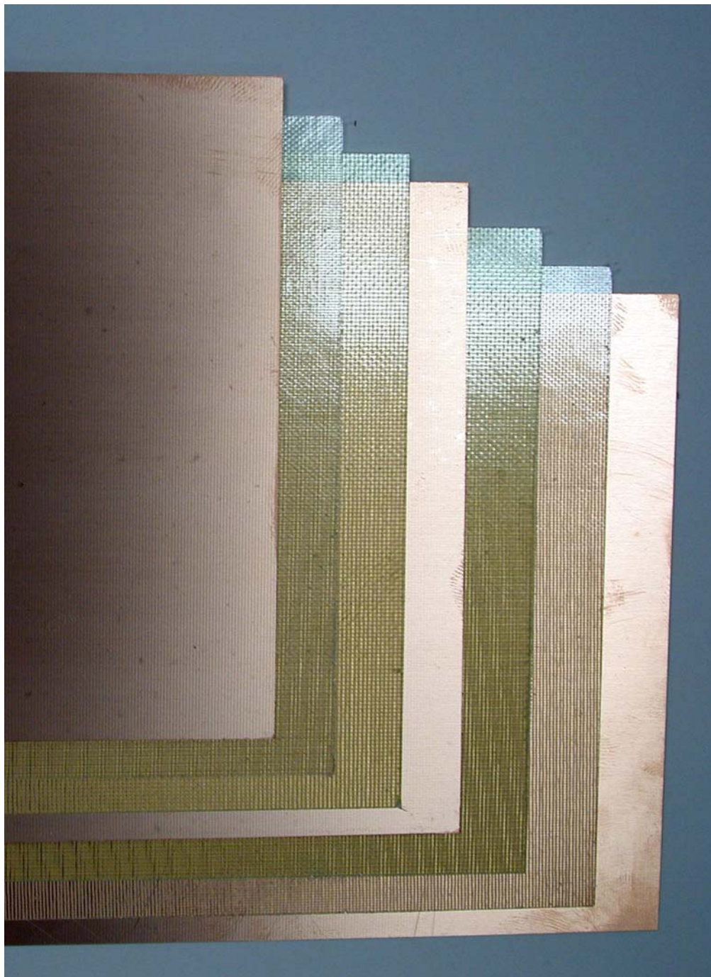
6-Lagen-Multilayer mit außenliegenden Kernen. Material von links nach rechts: Kern, 2 Prepregs, Kern, 2 Prepregs, Kern.
