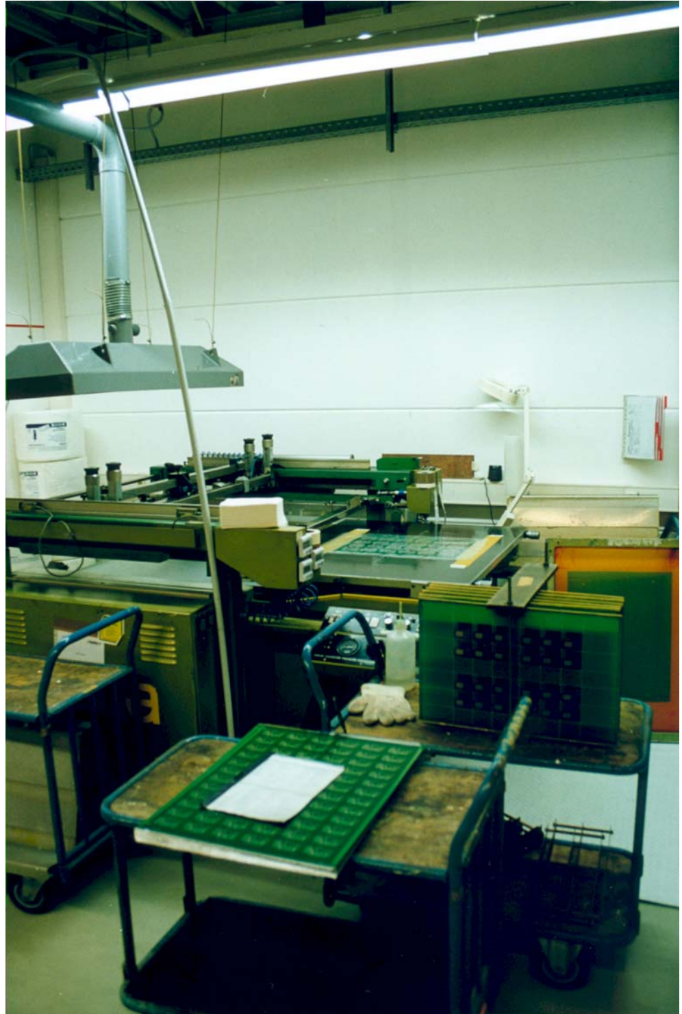
Maschine für diverse Siebdrucke (Fabrikat Svecia) in der Leiterplattenproduktion. Bildmitte, rechts, halb verdeckt, ein Sieb mit Rahmen.
