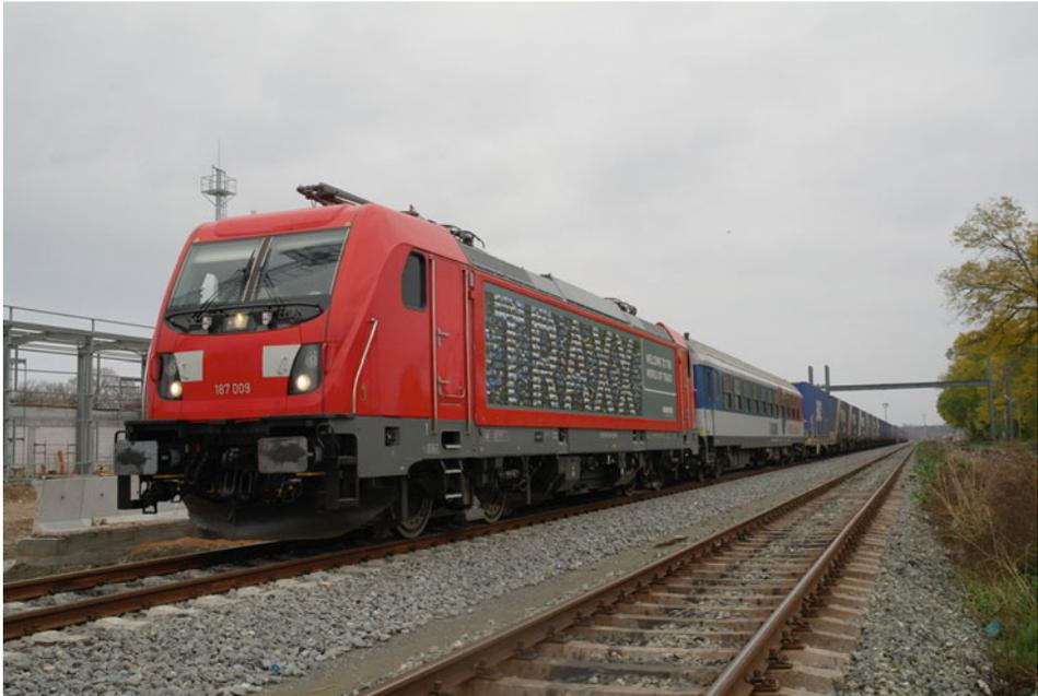
**Abb. 3.53** Hybridlokomotive TRAXX „Last Mile“. (Werkfoto: Bombardier)
