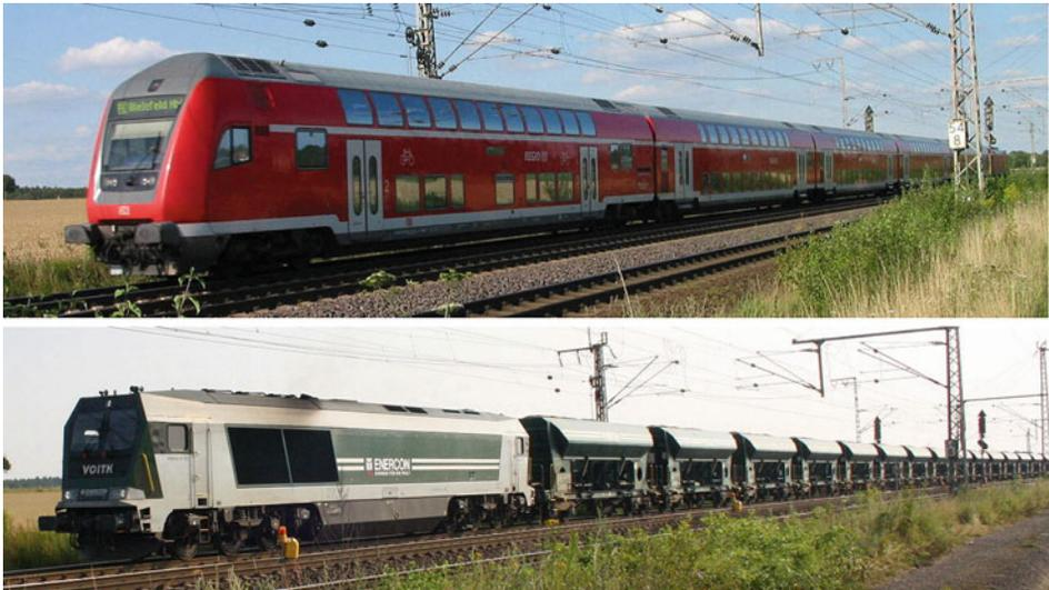
**Abb. 1.1** Eisenbahn. **a** Doppelstock-Wendezug, **b** Durchgangs-Güterzug
