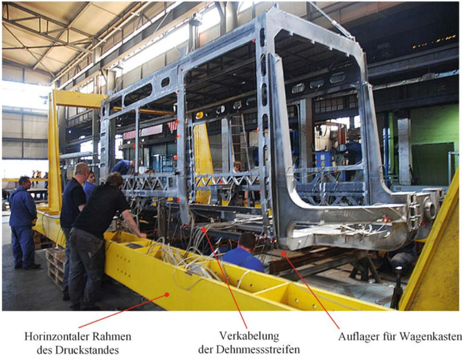
**Abb. 6.3** Einsetzen eines Straßenbahnwagenkastens in einen Druckstand für statische Tests. (Nach Werkfoto: PJ-Messtechnik)
