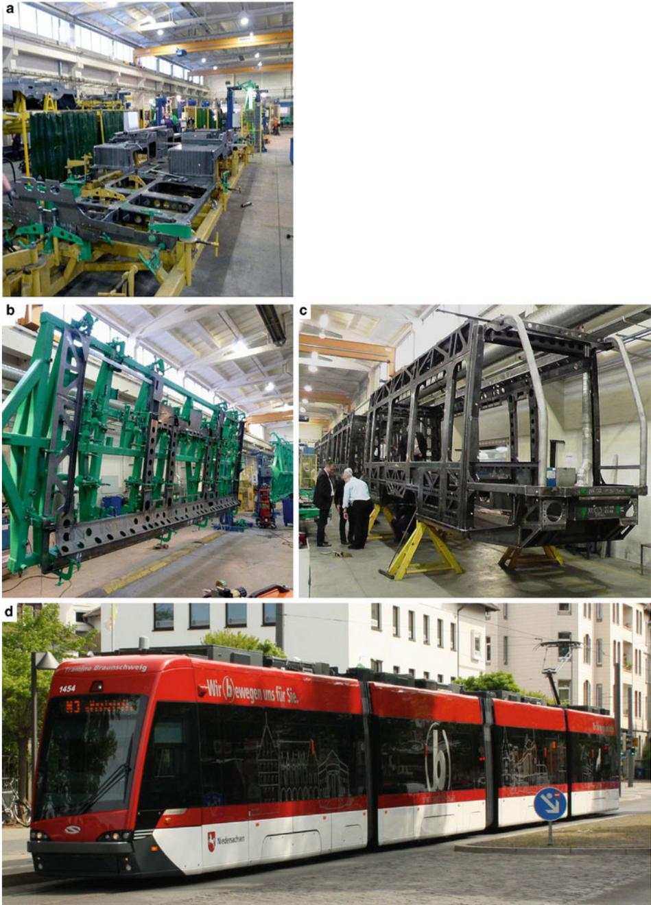
**Abb. 6.32** Vierteiliger Gelenkstraßenbahnwagen „Tramino“. **a** Untergestell und **b** Seitenwand in Schweißvorrichtungen, **c** Rohbauwagenkasten (nach Werkfotos: Solaris), **d** Fahrzeug im Einsatz
