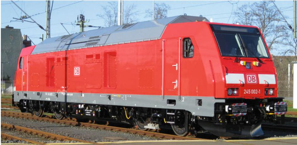
**Abb. 3.48** Mehrmotordiesellok Baureihe 245 der DB
