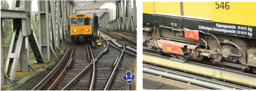
Kleinprofil-U-Bahn Berlin: Von oben bestrichene Stromschiene
