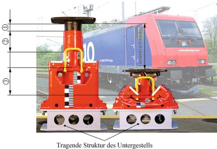
**Abb. 6.6** Verformungselemente an einer Elektrolok. (Nach Foto: Uwe Beika, TU Berlin, [https://www.schienevzg.tu-berlin.de/menue/forschung/passive\\_sicherheit/](https://www.schienevzg.tu-berlin.de/menue/forschung/passive_sicherheit/), aufgerufen am 10.02.2016)
