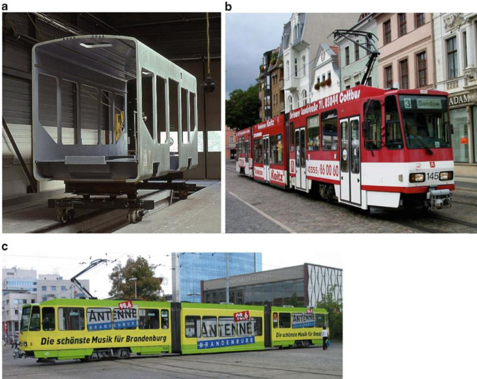
**Abb. 6.24** **a** Niederflur-Mittelteil für einen Straßenbahnwagen in Wickeltechnik (Foto: André Knoerr, Genf), **b** Türseite und **c** Nicht-Türseite eines Hochflur-Gelenkstraßenbahnwagens mit Niederflur-Mittelteil in Wickeltechnik
