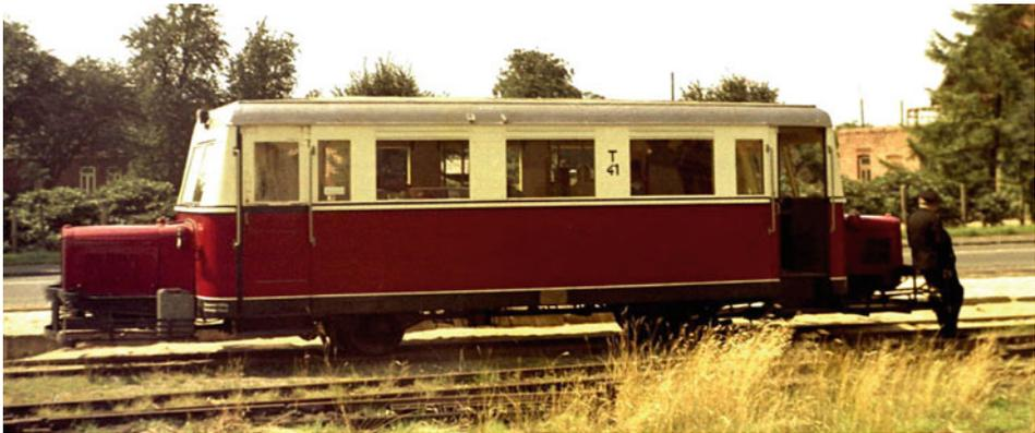
**Abb. 3.32** Schienenomnibus Bauart „Hannover“ der Waggonfabrik Wismar mit je einem Ford-Benzin-Vorbaumotor an jedem Wagenende
