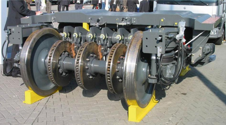
**Abb. 4.17** Drei Bremsscheiben auf einer Radsatzwelle des Siemens-Velaro RUS (Hochgeschwindigkeitszug für Russland)
