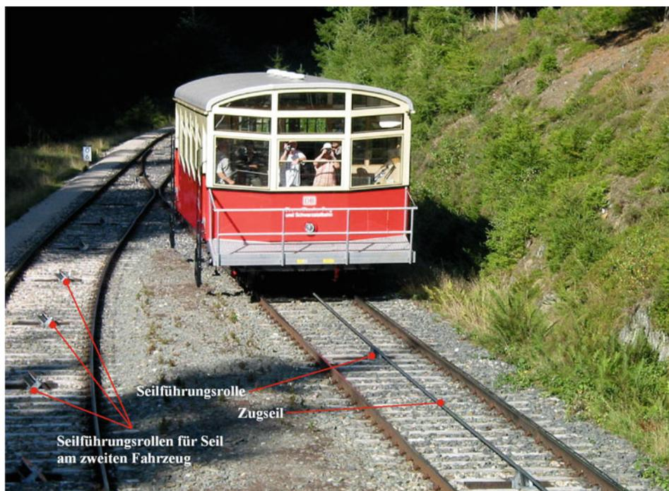
**Abb. 1.6** Standseilbahn (Oberweißbacher Bergbahn) in der Ausweiche in Streckenmitte; bergwärts fahrender Wagen
