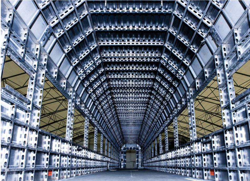
**Abb. 6.26** Wagenkasten eines ÖBB-Railjet-Wagens aus Stahl. (Werkfoto: Siemens)
