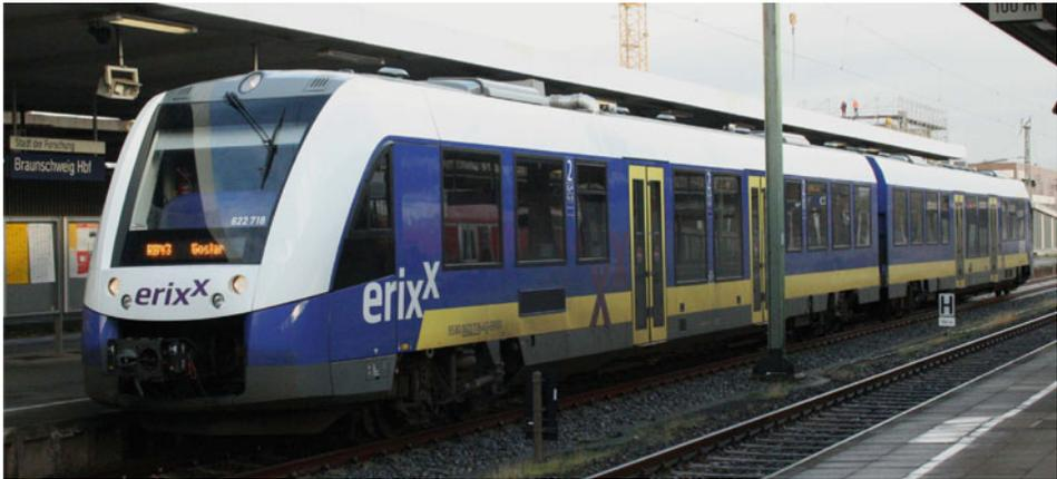
**Abb. 2.8** Zweiteiliger Dieseltriebswagen LINT 54 (Baureihe 622)
