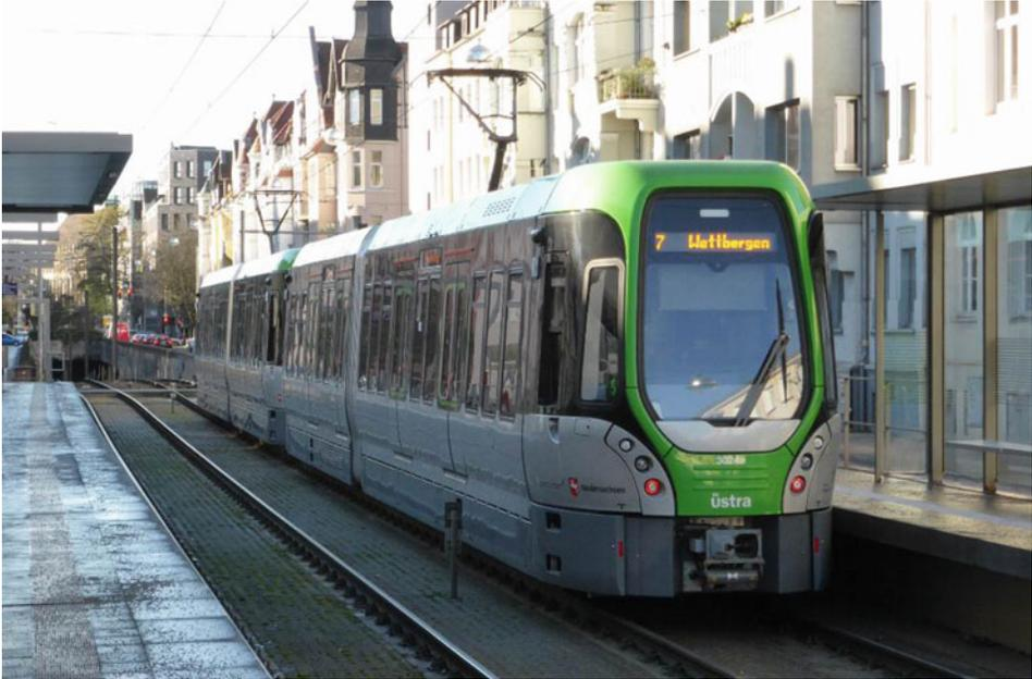
**Abb. 1.3** Stadtbahn auf eigenem Bahnkörper mit Hochbahnsteigen (Hannover); *im Hintergrund:* Tunnelrampe und Tunnel
