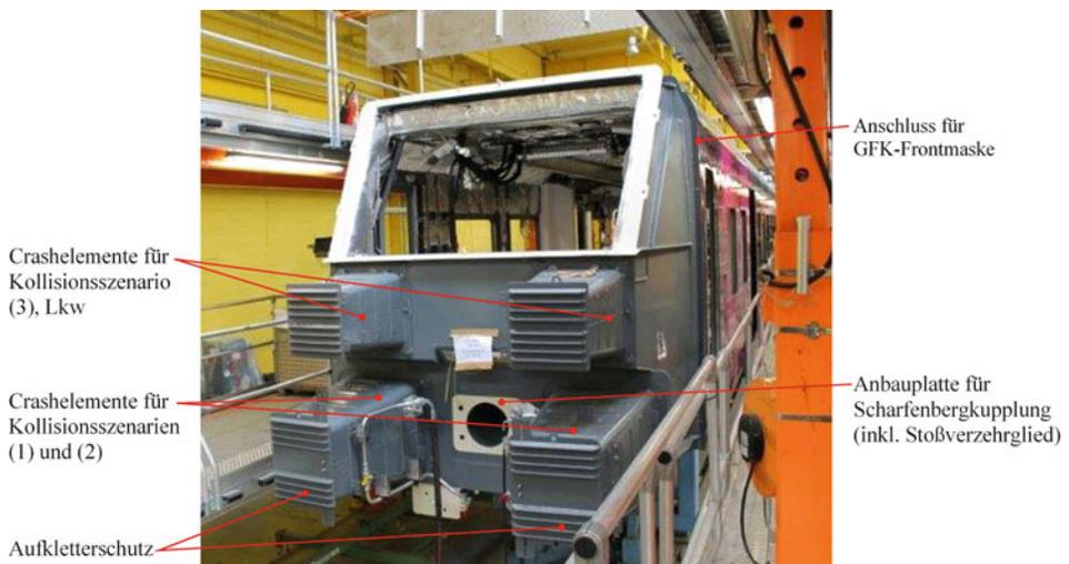
**Abb. 6.7** „Crashkopf“ des Elektrotriebwagens Coradia Continental. (Nach Werkfoto: Alstom)
