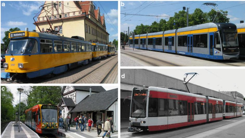
**Abb. 1.12** Straßenbahnwagentypen. **a** Einzeltriebswagen in Doppeltraktion mit Beiwagen (Leipzig), **b** 12-Achser-Gelenktriebwagen (Leipzig), **c** Duo-Gelenktriebwagen mit Dieselaggregat (Nordhausen), **d** 6-Achser-Gelenktriebwagen in Doppeltraktion (Halle/Saale)
