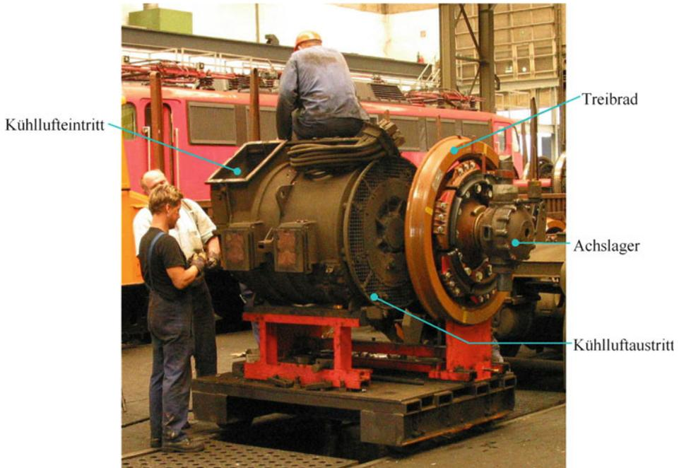
**Abb. 3.19** Einphasen-Wechselstrommotor einer Ellok Baureihe 141 der DB; Dauerleistung des Motors 578 kW
