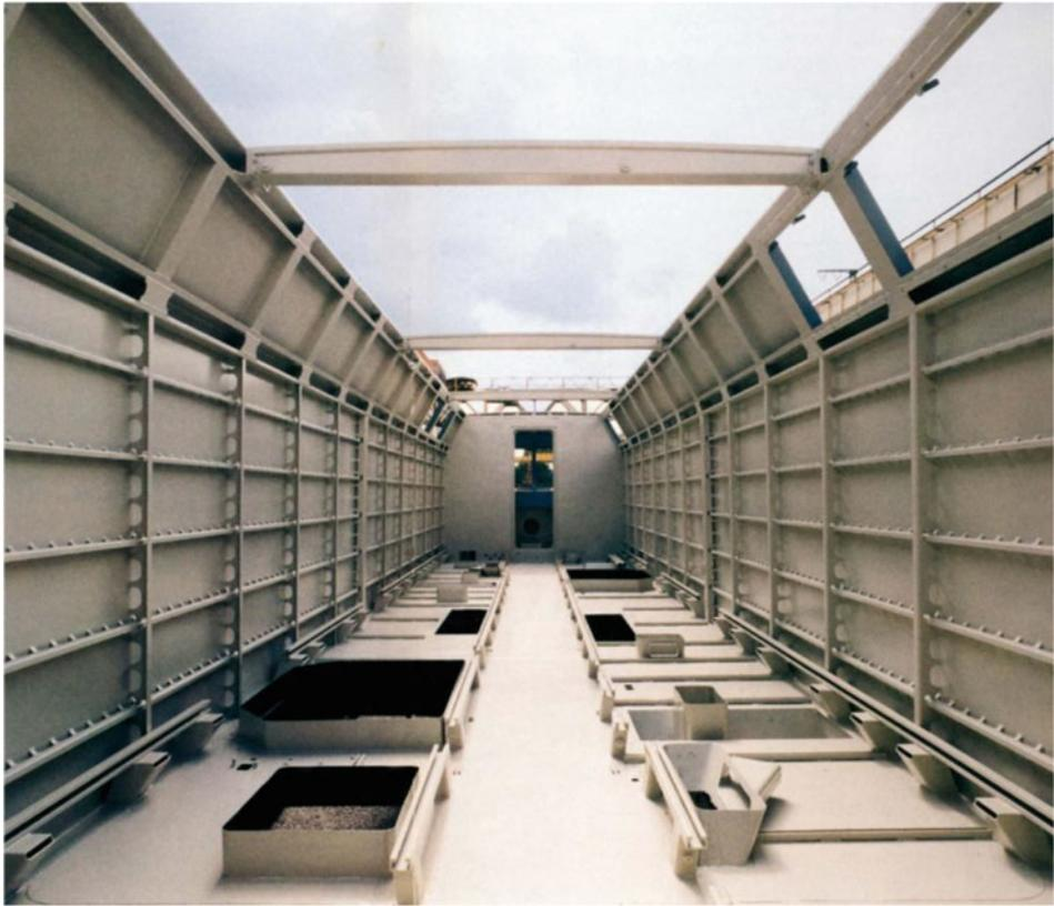
**Abb. 6.38** Fahrzeugkasten einer Elektrolokomotive Baureihe 152 der DB. (Werkfoto: Krauss-Maffei)
