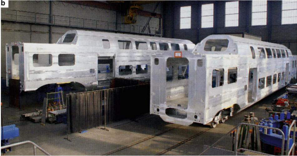
**Abb. 6.27** Rohbauten des Doppelstock-Elektrotriebwagens KISS. (Werkfotos: Stadler Rail)
