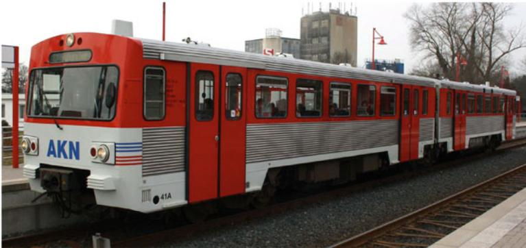
**Abb. 6.16** Wagenkasten des dieselelektrischen Doppel-Triebwagens VT2E; kombinierte Bauweise aus Baustählen S235JR und S355JR sowie Edelstahl X5CrNi18-10. (Skizze oben aus: Haug, A.: Waggonbau als Stahlbau. Der Stahlbau 47(1978)H. 6, S. 161–169 und H. 7, S. 205–211)
