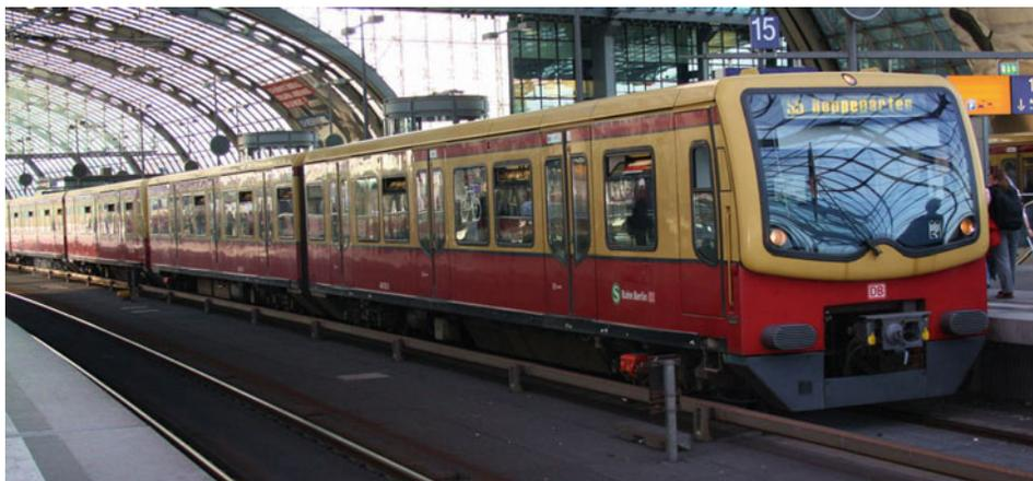
**Abb. 1.5** S-Bahn Berlin (beachte: Stromschiene, Mittelpufferkuppung)
