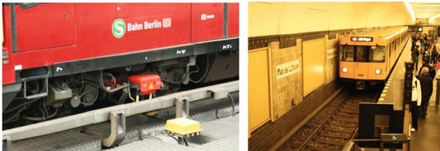
S-Bahn Berlin, Großprofil-U-Bahn Berlin: Von unten bestrichene Stromschiene
