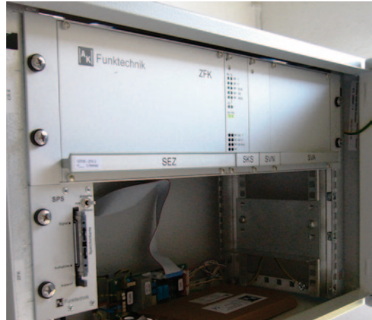
Abb. 17.22 Sende- und Empfangsgerät des VZF95 mit digitalem Nachrichtenspeicher, Fa. AK Funktechnik GmbH
