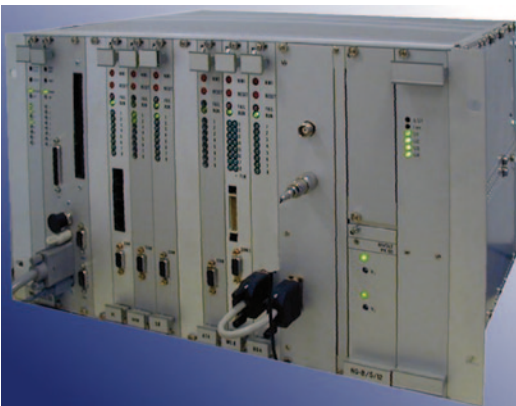
Abb. 17.28 Zentrale Baugruppen, System MACS der Fa. Wenzel Elektronik GmbH
