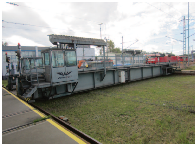
Abb. 15.21 Schiebebühne, 3 AC 400 V 50 Hz
