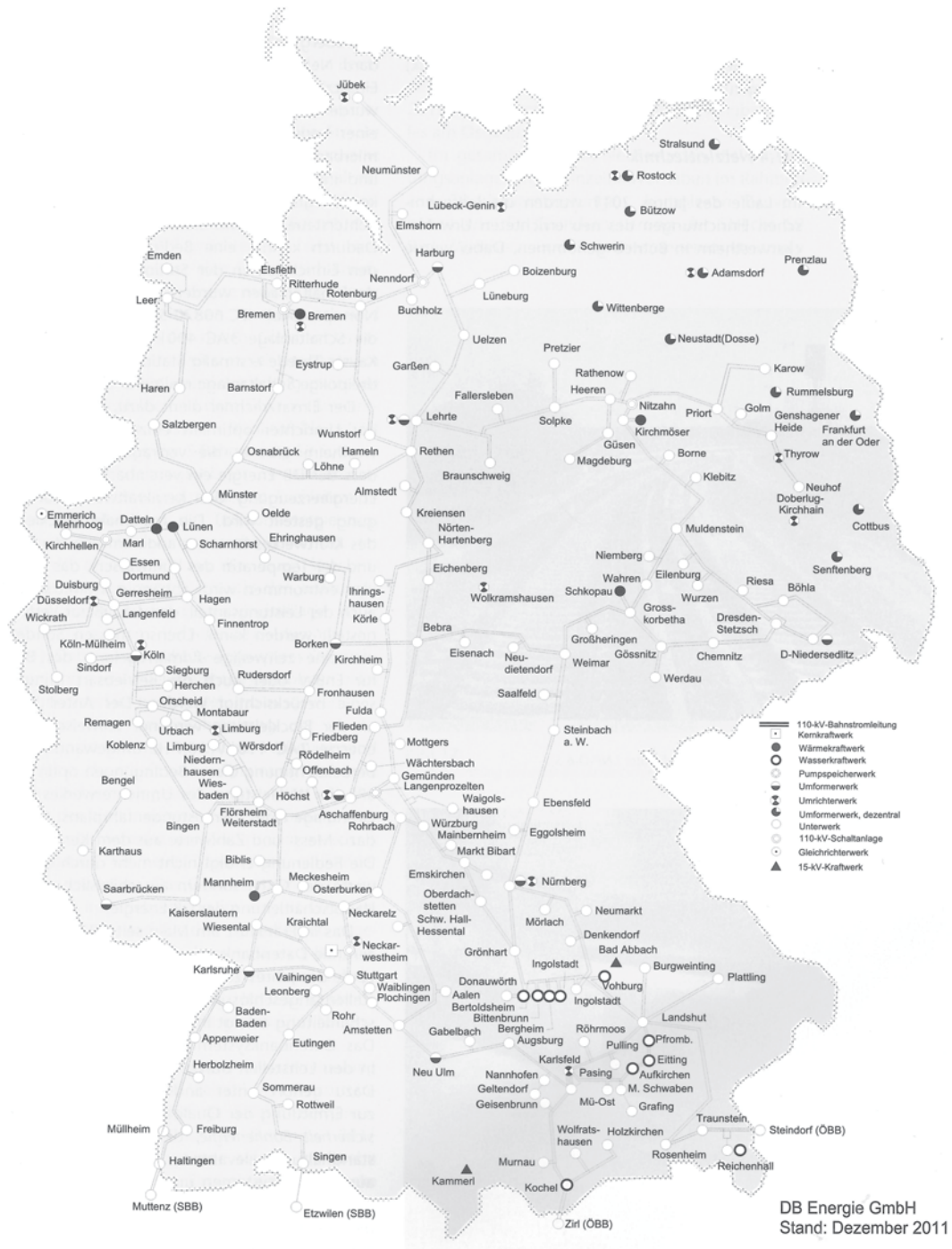
Abb. 14.8 Netzstruktur des 2 AC 110 kV 16,7-Hz-Bahnstromnetzes der DB Energie. Aus: Elektrische Bahnen, Heft 3/2012
