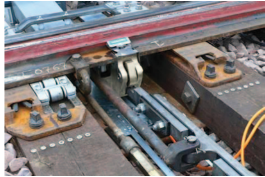
Abb. 5.54 Klinkenverschluss mit Schieberstange (rechts), Prüferstange mit Anschluss an die Zunge (Mitte), Zungenroller (links)
