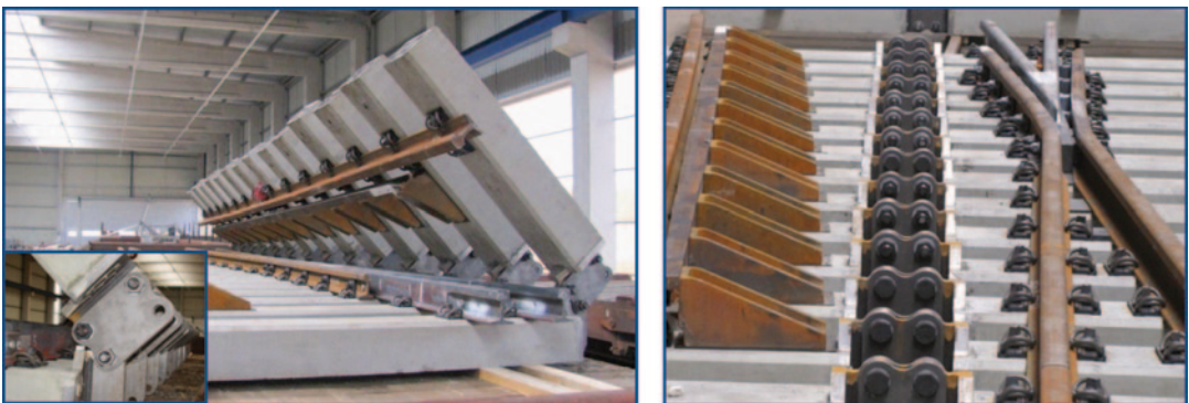
Abb. 5.60 Weiche mit Klappschwelle auf Flachwagen
