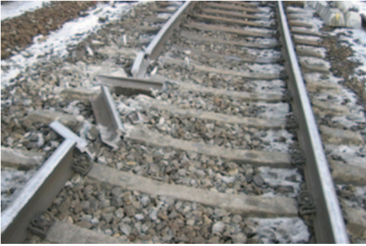
Abb. 3.23 Trümmerbruch mit einer Länge von 2,23 m auf Grund von Head Checks. (Quelle: Archiv Alfred Wöhhart)
