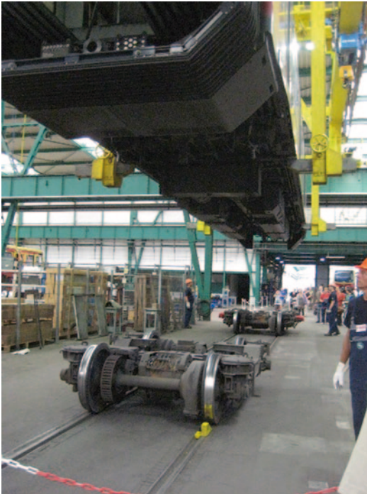
Abb. 15.28 Krananlage in einem Instandsetzungswerk der DB AG
