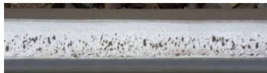
Abb. 3.22 Head Checks („gerade“) an Schiene der Schienenstahlsorte R 260. (Quelle: Alfred Wöhhart)
