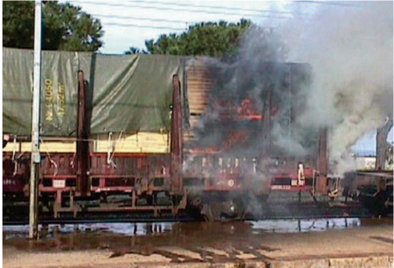
Abb. 17.35 Brand, ausgelöst durch feste Bremse
