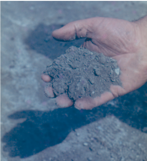
Abb. 4.21 Boden-Kalkgemisch hat gute Krümelstruktur, zeigt optimale Reaktion
