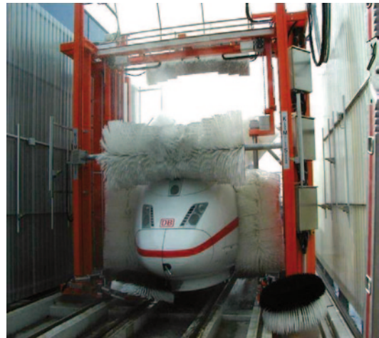
Abb. 15.27 Waschanlage für die Außenreinigung
