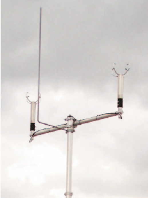
Abb. 17.39 Windsensoren System „Mistral“, Fa. SST Signal- und Systemtechnik GmbH
