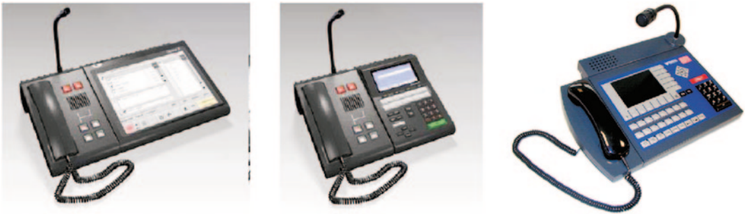
Abb. 17.8 GeFo vom Typ Dicora S und C (Fa. Frequentis) sowie vom Typ U-48 (Fa. Wenzel)
