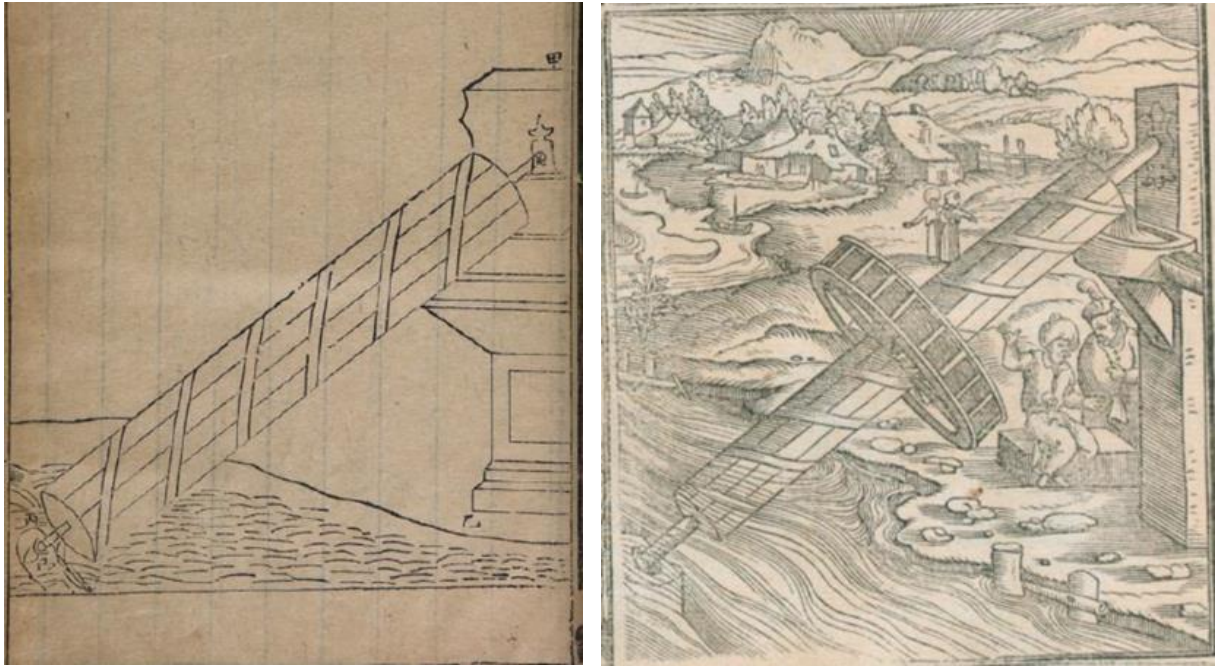
Abbildung 3: Archimedische Schraube, links im Taixi shuifa 泰西水法 (1612), Edition Tianxue chuhan 天學初函 (1626; Nachdruck 1965), rechts in De Architectura , Edition Daniele Barbaro (1556)
