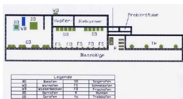
Abb. 4: Rekonstruktion der technischen Einrichtung der Saigerhütte in Agricolas „De re metallica“ in der Seminararbeit der Studierenden des IWTG.
