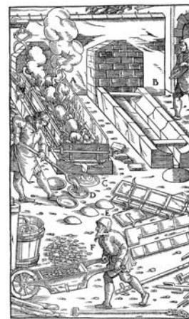
Abb. 1: Saigerherd nach GeorgiusAgricola „De re metallica“ (1556).
