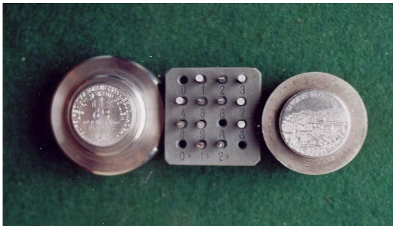
Bild 7: Die Prägestempel für die Ausbeutemedaille und die Zahlen zur Numerierung
