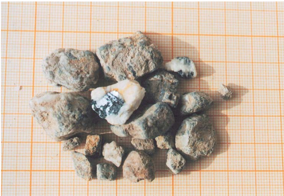
Bild 3: Gewonnener Bleiglanz mit Schwerspat ver- gesellschaftet, z. T. stark verkrus- tet
