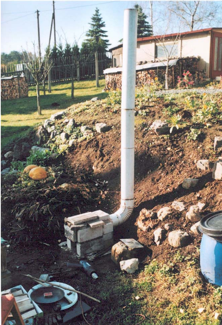
Bild 4: Schmelzofen zum Ausschmelzen von Blei aus partiell abgeröstetem Bleiglanz
