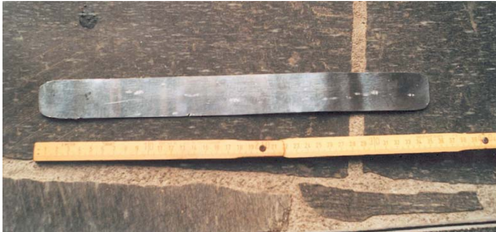
Bild 5: Gewalzter Zain, aus dem die Ronden ausgestanzt werden
