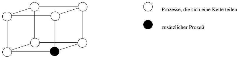
Abbildung 11: Eine Gruppe von Prozessen wird um einen zusätzlichen Prozeß erweitert, um wieder einen Hypercube aufzuspannen.
