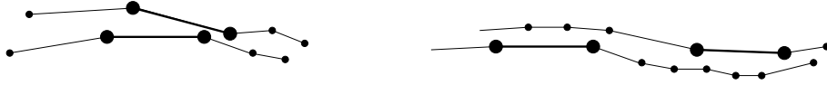
Abbildung 4: Ausschnittsskizze eines deformierten Netzes mit Riß bei kleinen (links) und größeren Verschiebungen (rechts)
