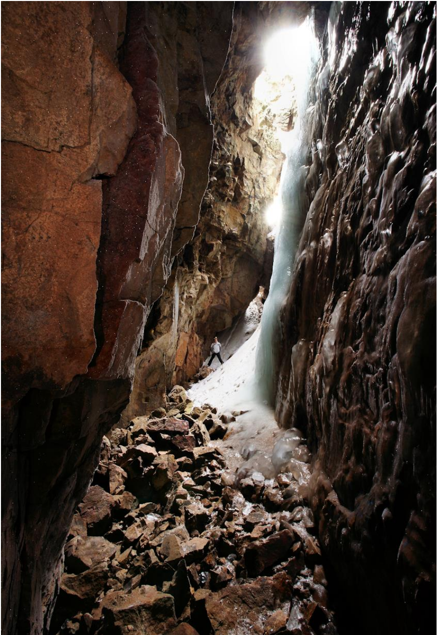
Abbaue auf dem Gang Wildbahn in der Fortsetzung des Pingenzuges, die Person in der Mitte des Bildes gibt einen Anhaltspunkt für deren Dimension (Foto: J. Albrecht).
