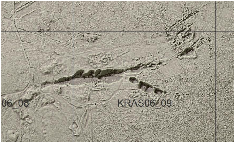
Laserscan des Reviers Vorder Hengst (Visualisierung O. Malina). Auf dem Scan als auch auf der Putz'schen Karte ist eine große Pinge im Raum der Roten Grube mit Streichen ONO-WSW sichtbar, wie auch ein quer zu ihr verlaufender Pingenzug der Gänge Pachmann und Wildbahn des Streichens WNW-OSO. Während auf der Putz'schen Karte zwei Pingen an der Stelle der Schächte Löwen und Gnade Gottes zur Roten Grube markiert sind, kann man auf dem Laserscan zusätzlich eine dritte Pinge im Bereich der Schächte Pantaleon und Wildbahn erkennen. Im nordöstlichen Teil der Karte, wie auch auf dem Laserscan sind enge Abbaue (Pingen) des Streichens NO-SW auf den Gängen Prophetes, St. Johannes und Siebente Maß gut sichtbar. Diese werden nach Norden durch die umfassende tektonische Störung, die so genannte Fäule beendet.
