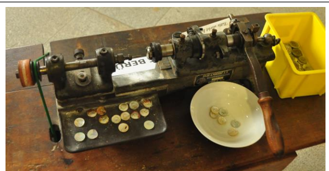
Die gleiche Maschine wurde oft auch verwendet, um die Löcher in die Knöpfe zu bohren.
