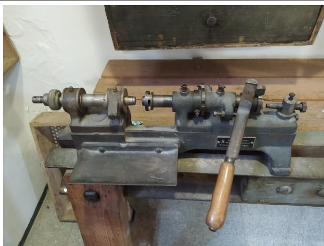
Mit solchen einfachen Maschinen wurden die Knopfkörper aus den Muschelschalen geschnitten.
