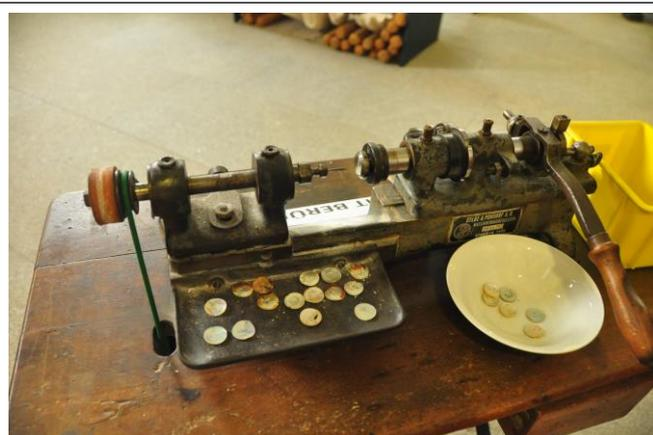
Fußgetriebene Bohrmaschine für die Löcher in den Knöpfen
