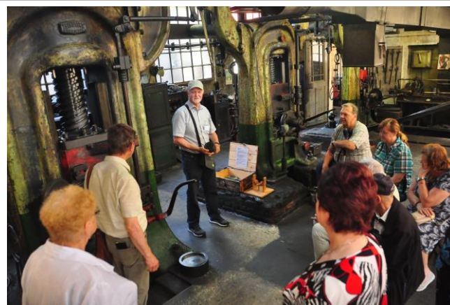
Vor den transmissionsbetriebenen Spindelpressen
