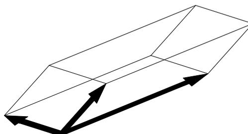
$$V = |(\vec{a}\vec{b}\vec{c})| = |(\vec{a} \times \vec{b}) \cdot \vec{c}| = |\vec{a} \cdot (\vec{b} \times \vec{c})|, \quad \vec{b} \times \vec{c} = \begin{pmatrix} 1 \\ 4 \\ 5 \end{pmatrix} \times \begin{pmatrix} 2 \\ 1 \\ -2 \end{pmatrix} = \begin{pmatrix} -13 \\ 12 \\ -7 \end{pmatrix} \quad (\text{s. Aufgabe 7.40})$$
