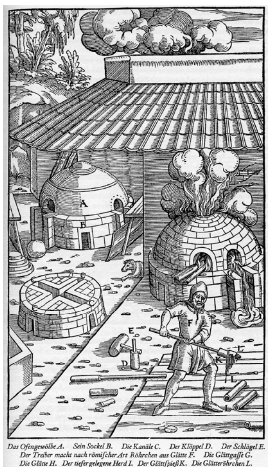
Bild 3 – Der Freiburger Treibofen, G. Agricola: De re metallica libri XII
