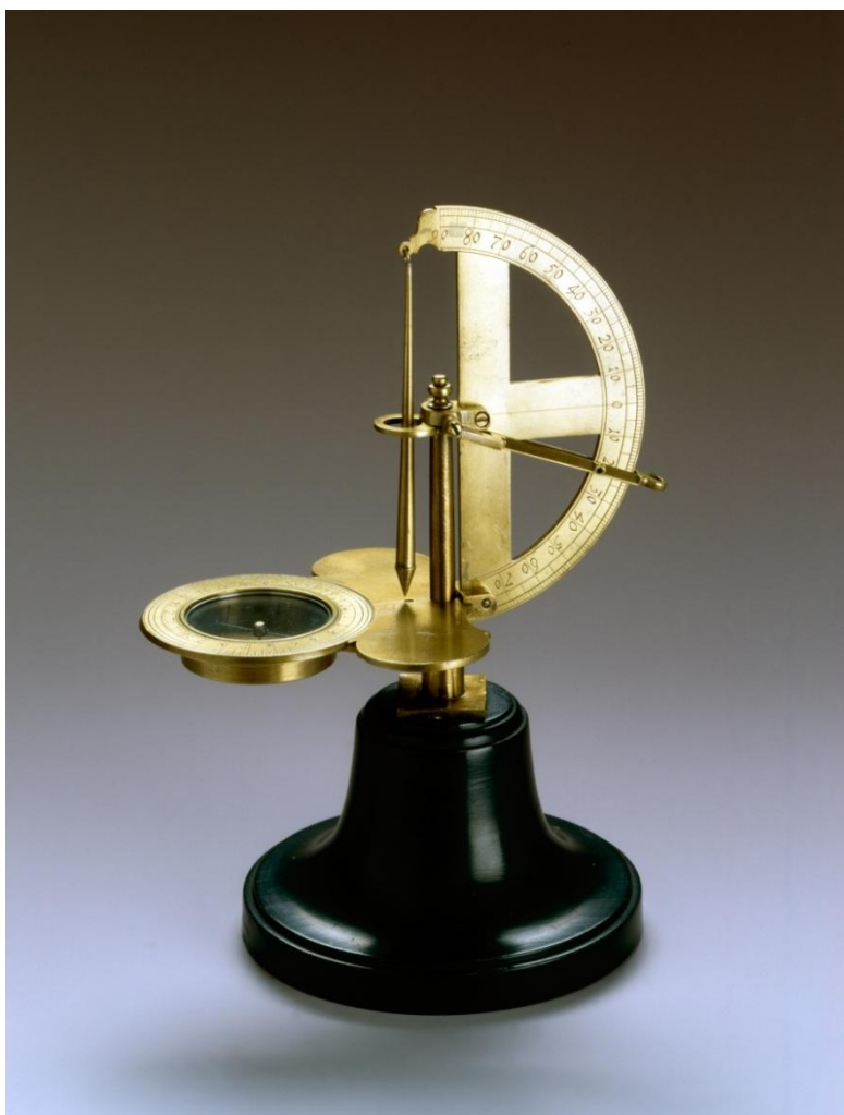
Abb. 16 Schinzeug-Hauptgerät, Anfang 18. Jh., Messing, graviert, L = 18 cm, B = 11,2 cm, H = 17 cm, Math.-Phys. Salon, Inv.-Nr. C III d 4, Foto: Jürgen Karpinski
