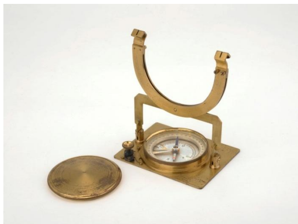
Abb. 18 Steigerkompass nach Studer, 2. Hä. 19. Jh., Messing, Teilkreise versilbert, Grundplatte: L = 10 cm, B = 7,6 cm Kompaß: D = 6,3 cm, Math.-Phys. Salon, Inv.-Nr. C IV 10, Foto: Peter Müller
