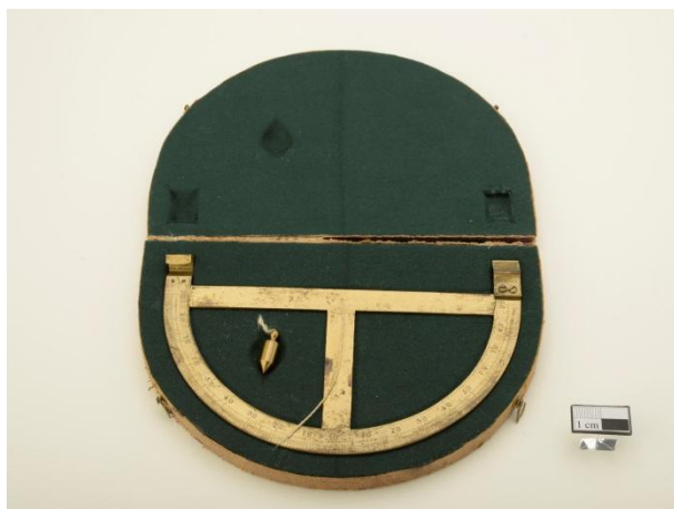
Abbildung 14 Gradbogen mit gegenständigen Aufhängehaken, 19. Jh., Messing, graviert, punziert Math.-Phys. Salon, Inv.-Nr. C III c 21, Foto: Peter Müller
