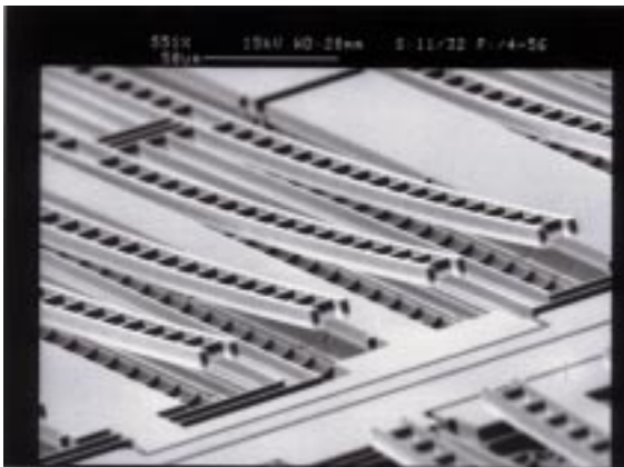
Bild 13 Antriebsstruktur (922 μm × 100 μm) mit dargestellter z-Auslenkung
